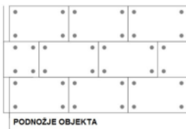
4 pričvrsnice/ploča ili 6 kom/m 2 fasade
