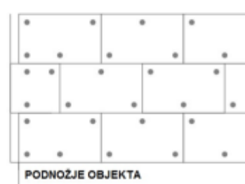
5 pričvrsnica/ploča ili 8 kom/m 2 fasade
