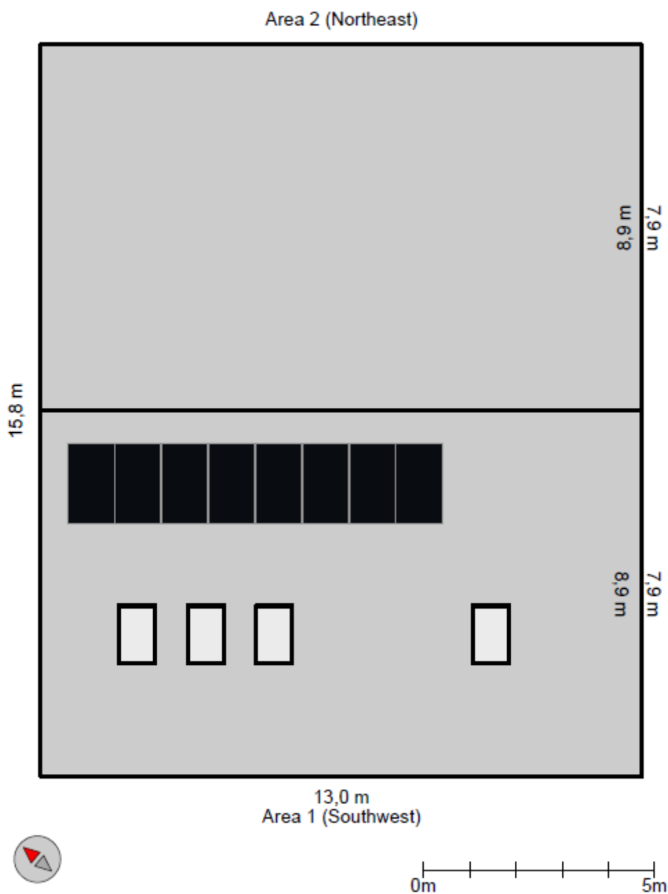
Prikaz pozicioniranja modula na krovu zgrade
