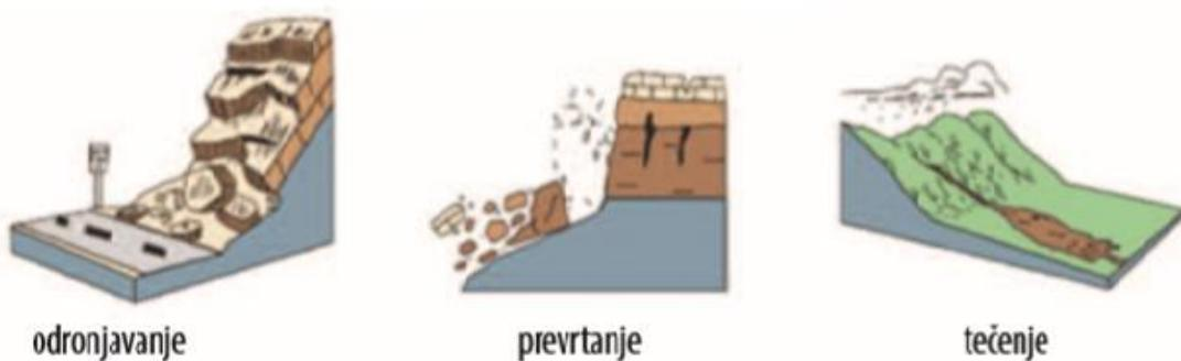
Slika 17: Prikaz osnovnih tipova klizanja prema mehanizmu kretanja
